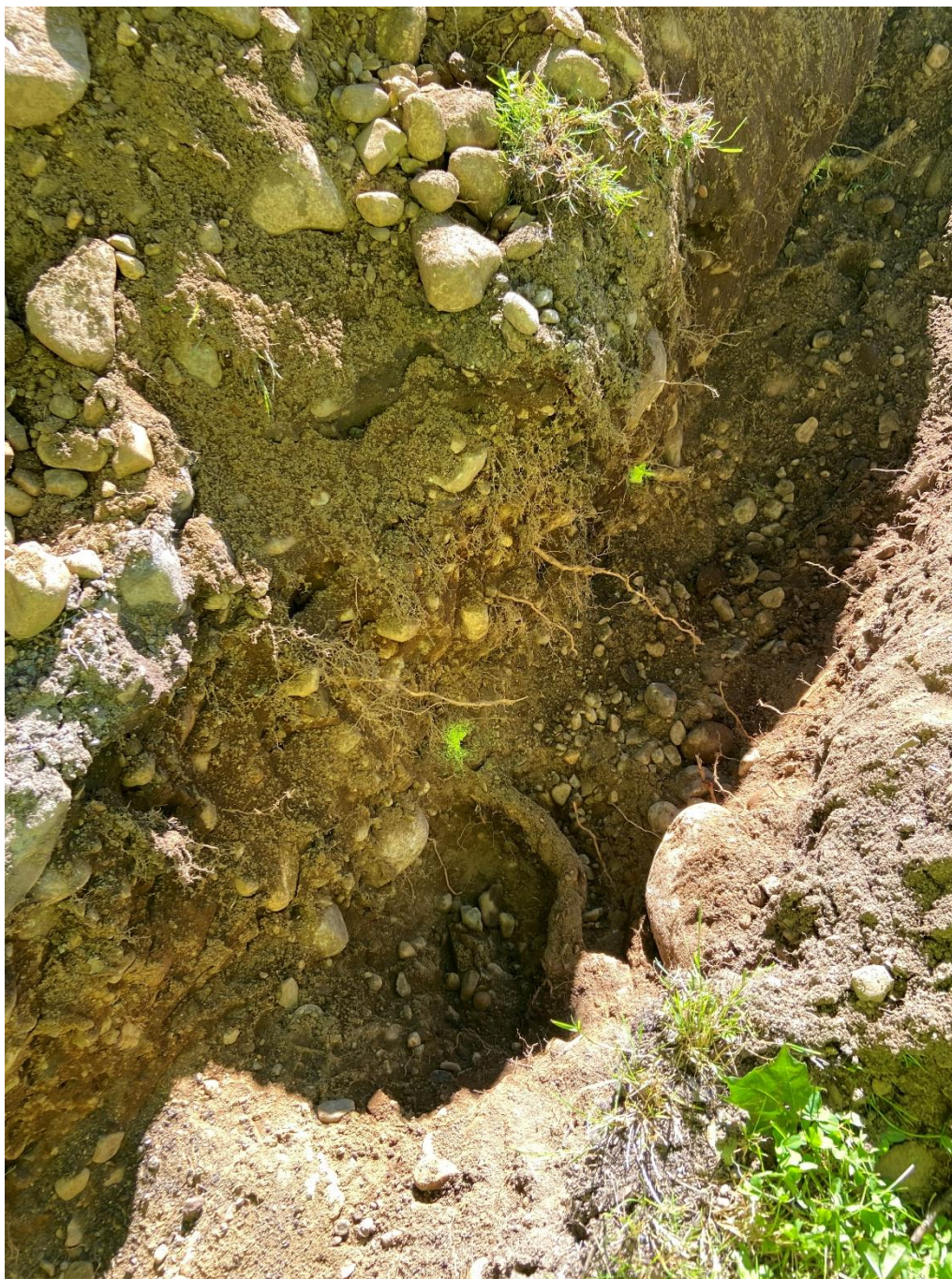
Figur 0-14. Prøvegraving utført ved eik V13 viser at mindre røtter blir berørt av tiltaket. Foto: Vestfold fylkeskommune.
